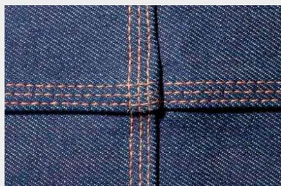
Conta com **sistema de alívio de pressão do calcador** para evitar falhas de pontos e desencontros de costura.
