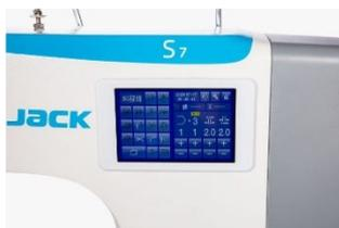
**Tela Sensível ao Toque** de 5 polegadas é fácil de usar e permite alterar a velocidade, o comprimento do ponto, os modos de costura e outros parâmetros.
