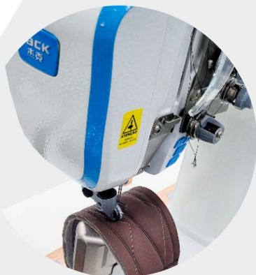
Com transporte por rodízios superior e inferior independentes a máquina é computadorizada com controle inteligente. Além do motor do eixo principal, a máquina possui outros 3 motores de passo: um na barra de agulhas para a transporte da agulha e os outros dois independentes nos rodízios aos quais o diferencial pode ser ajustado. Tudo isso permite uma costura mais precisa, rápida e silenciosa.
