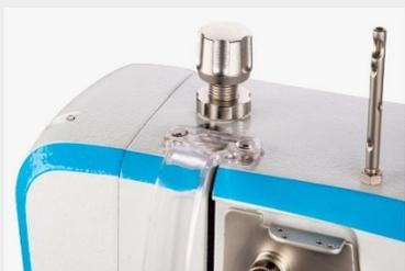
Ajuste a pressão do rolo com rapidez e precisão usando um parafuso localizado na parte superior da máquina.
