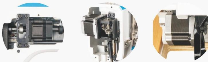
Além do motor do eixo principal, a máquina possui outros 3 motores de passo: um na barra de agulha para a alimentação da agulha e os outros dois independentes no rodízio aos quais o diferencial pode ser ajustado. Tudo isso permite uma costura mais precisa, rápida e silenciosa.
