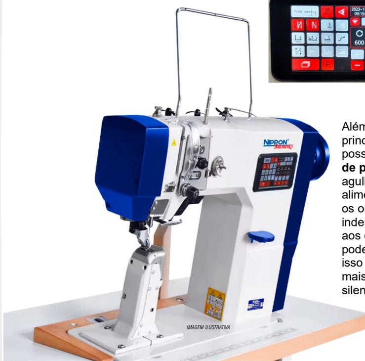
Além do motor do eixo principal, a máquina possui outros **3 motores de passo**: um na barra de agulha para a alimentação da agulha e os outros dois independentes no rodízio aos quais o diferencial pode ser ajustado. Tudo isso permite uma costura mais precisa, rápida e silenciosa.
