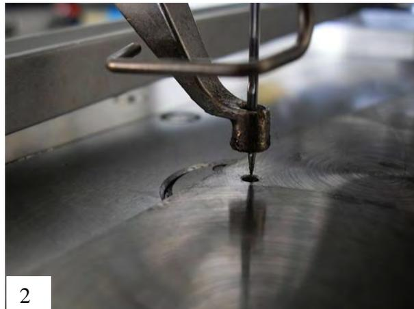
El punto origen de la máquina se regula, para el eje X, desplazando la cuchilla de lectura sensor, aflojando los tornillos con una llave Allen de 3 mm y deslizando la cuchilla hacia la derecha o la izquierda.
