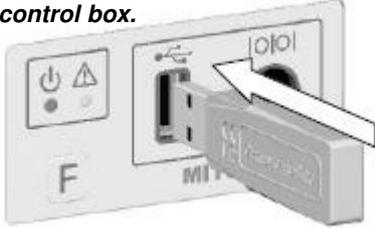
Encender la máquina manteniendo apretada la letra **F** y mantenerla apretada hasta el encendido del **LED ROJO**.
