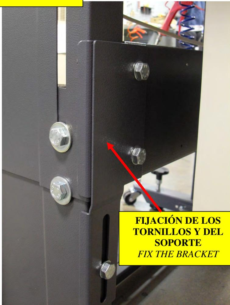
**FIJACIÓN DE LOS TORNILLOS Y DEL SOPORTE**
