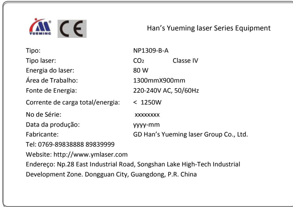
Figure 1-6: Placa de identificação NP1309-B-A
