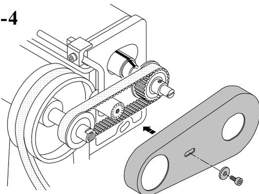
拉布輪的動作量應比送齒稍大,但差率太多時拉布輪及布料則易磨損
