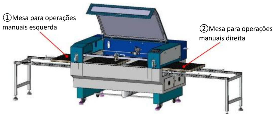
Fig.1-14 Mesa para operações manuais tipo intercambiável
