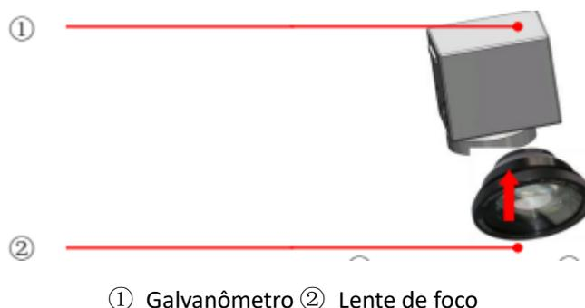
Fig. 3-9 Instalação do espelho do scanner e da lente de foco
