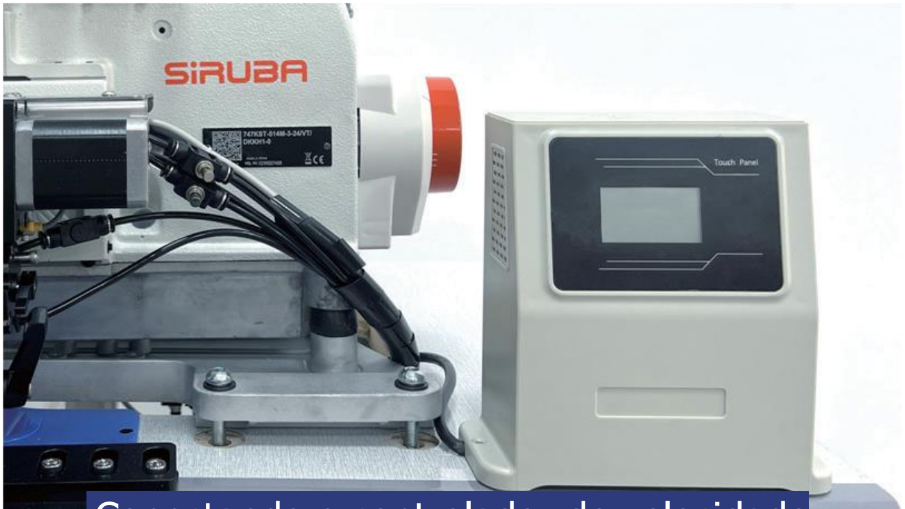
Conectando o controlador de velocidade
